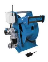
Avvolgitubo in acciaio verniciato o acciaio inox AISI 304 con riavvolgimento motorizzato tramite motore elettrico collegato ad un riduttore esterno con limitatore di coppia a frizione, adatto per impieghi a distanze no a 60 m con tubo da 1/2".
