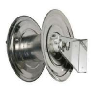
Avvolgitubo manuale in acciaio inox AISI 304 a supporto singolo adatto per impieghi a distanze fino a 35 mt con tubo Ø 1/2". L'arrotolatore viene fornito di serie senza tubo e può essere utilizzato per il riavvolgimento di tubi per olio, antigelo, grasso, aria e acqua. Pressione massima di lavoro 200 bar, temperatura massima 150°C, guarnizioni in EPDM.
